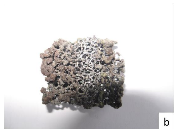
Abbildung 8: Keramikprobe vor a) und nach b) 100 Stunden im Pelletkessel
