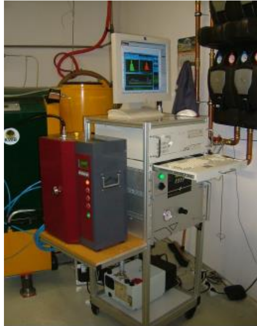
Abbildung 26: Messung der Partikelgrößenverteilung mit dem ELPI an einem Holzpelletkessel.
