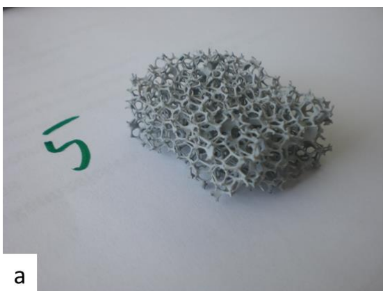
Abbildung 8: Keramikprobe vor a) und nach b) 100 Stunden im Pelletkessel
