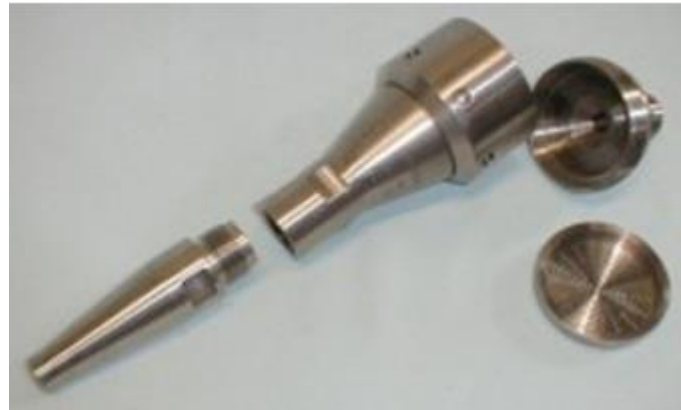
Abbildung 27: Planfilterkopfgerät nach VDI 2066 – 2.
