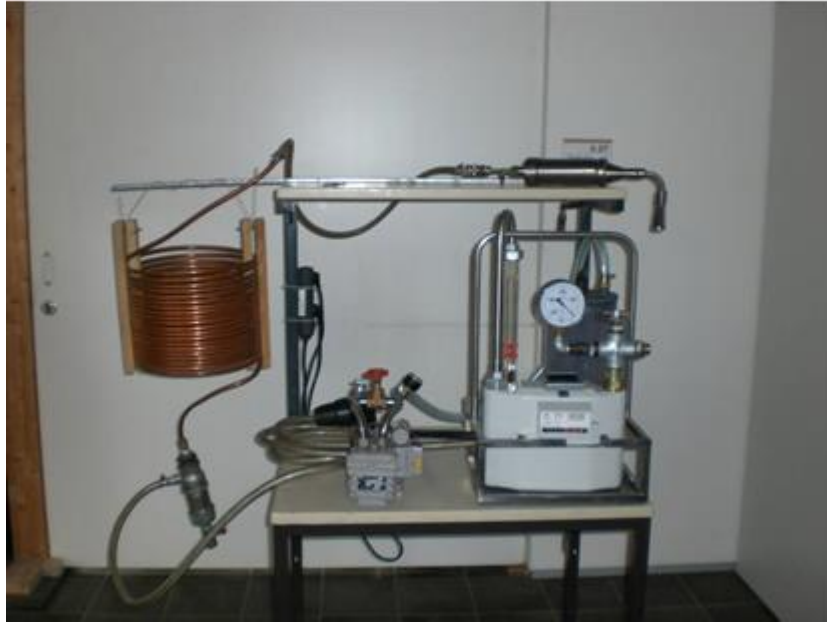
Abbildung 29: Probenahmesystem für die Messung mit dem Planfilterkopfgerät nach VDI 2066.
